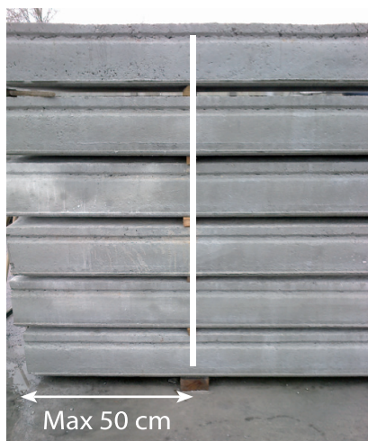
Rysunek 6. Ilustracja ułożenia podkładek dystansowych
