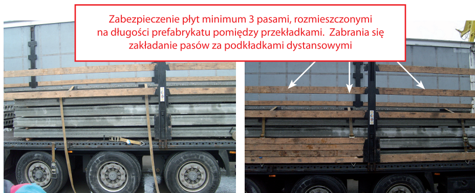
Rysunek 7. Zabezpieczenie ładunku płyt na czas transportu
