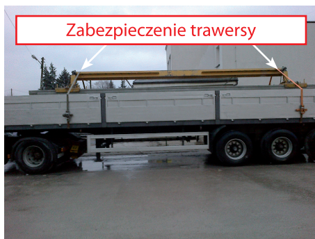
Rysunek 8. Zabezpieczenie ładunku płyt i trawersy na czas transportu
