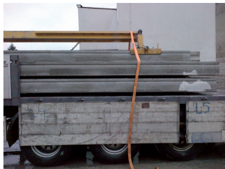
Rysunek 8. Zabezpieczenie ładunku płyt i trawersy na czas transportu
