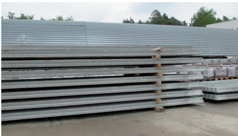
Fot. 3 Prawidłowe magazynowanie belek stropowych MASTER
