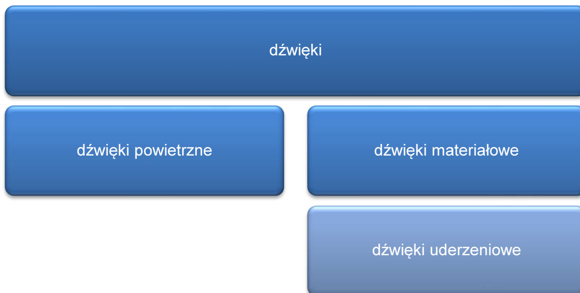
Rys. 1. Schematyczne przedstawienie podziału stosowanego przy analizie dźwięków występujących w budynku.
