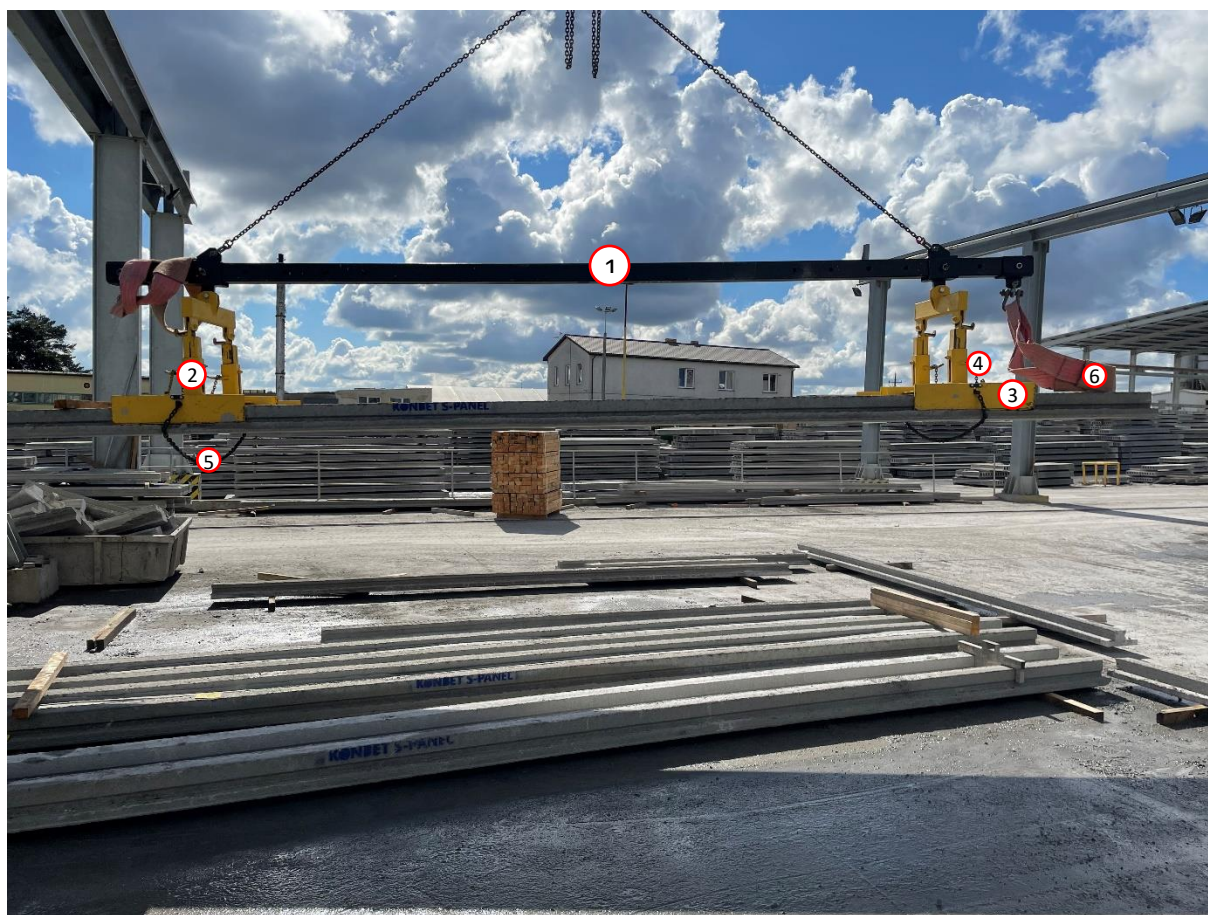
1 – Trawers 2 – Chwytek 3 – Szczęki chwytaka 4 – Łańcuch podnoszący szczęki 5 – Łańcuch asekuracyjny 6 – Zawiesia pasowe
